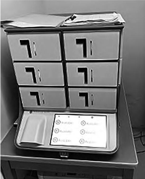
図1 FilmArray: 専用のパウチをセットして測定する装置
