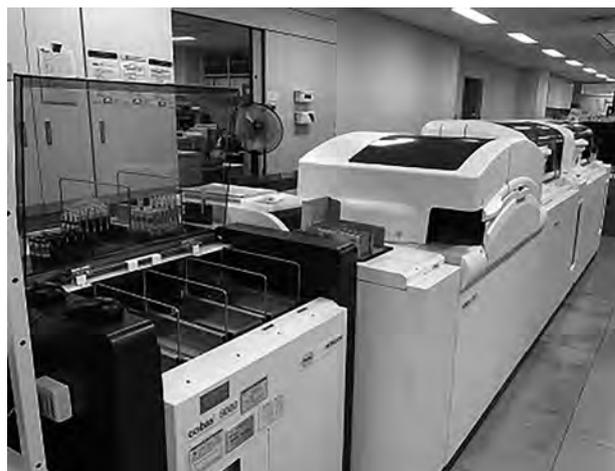
図3 免疫測定法（ECLIA法）コバス8000：抗体検査を行う測定装置
